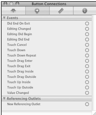
Rysunek 3.12. Inspektor połączeń pokazuje zdarzenia dostępne dla zaznaczonego przycisku
